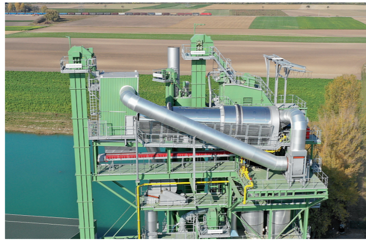
Grafik: AMA Hausleiten (STRABAG, 2018), Paralleltrommel mit Rekuperator
