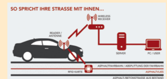
Permanente, berührungslose Kommunikation mit der Straße
