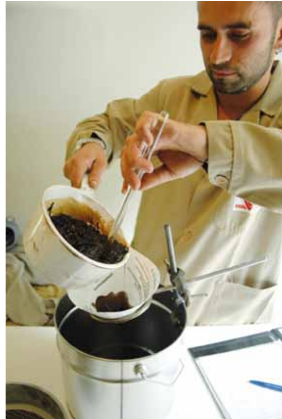
Überprüfung des Bindemittelgehaltes vor Ort
