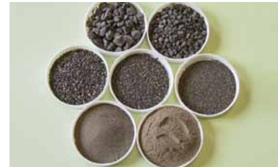
Zertrümmerung von Splitt 4/8 auf 0/5 innerhalb von 3 Wochen
