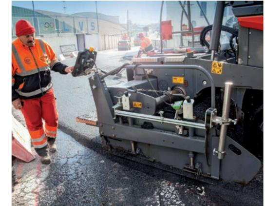
Super Bedienung: Die neu konzipierte Bohlen-Bedienkonsole.
