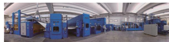
Bild 2: Herstellung von RVS Asphalt-Vlies
