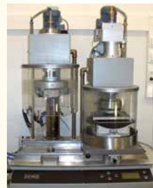
Abb. 1: Links Prüfanlage nach Wehner / Schulze PWS (links die Polierstation, rechts die Prüfstation). Rechts die erfasste Messwertkurve, der Schnittpunkt der geglätteten Kurve (rot) mit der 60 km/h-Linie entspricht \mu PWS
