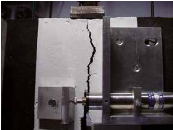
Abbildung 11: Riss in unbewehrter Probe nach 80.000 Lastspielen
