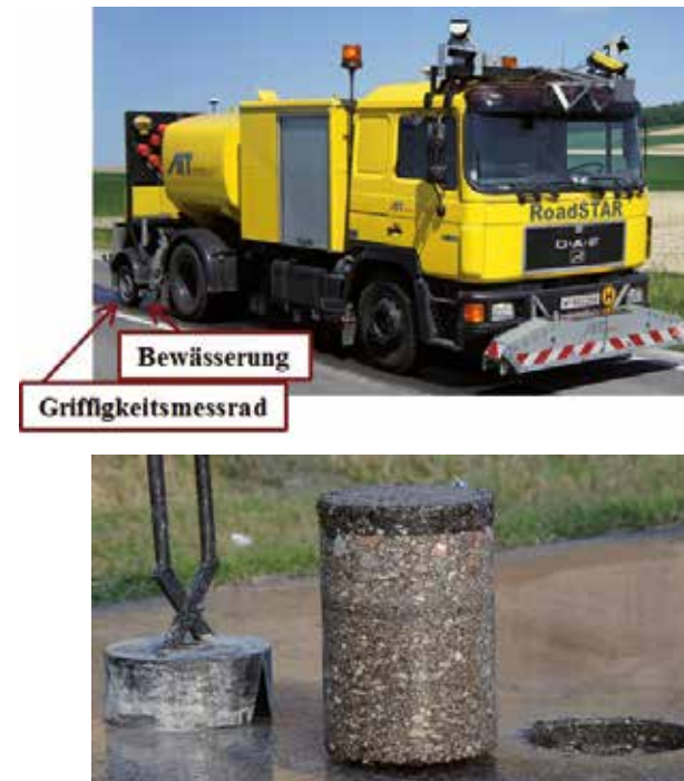
Abb. 2: oben: Messung der Straßengriffigkeit mit dem System RoadSTAR, unten: Bohrkernentnahme
