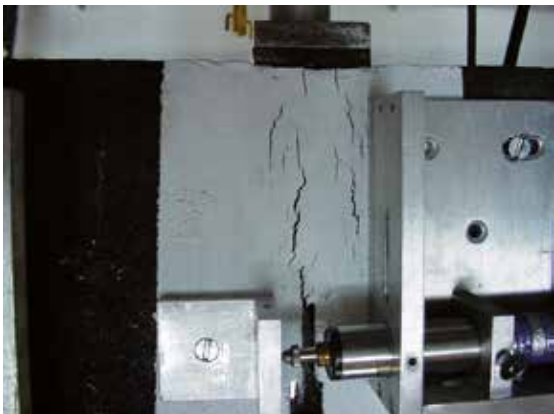
Abbildung 12: HaTelit bewehrte Probe nach 480.000 Lastspielen
