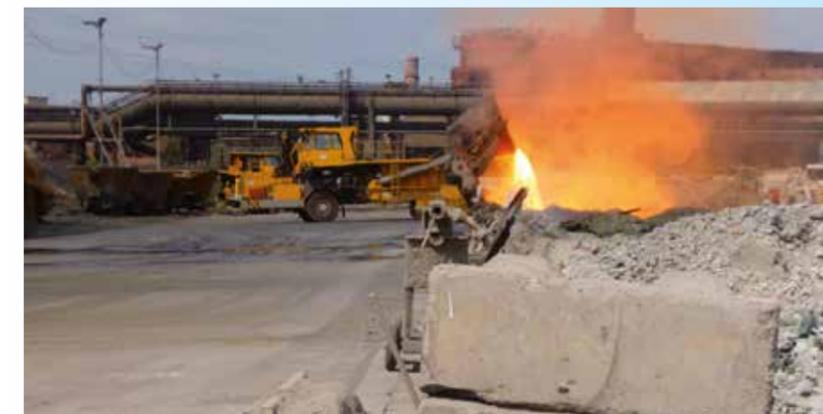
Abkippen der heißen Stahlschlacke in das Schlackenbeet
