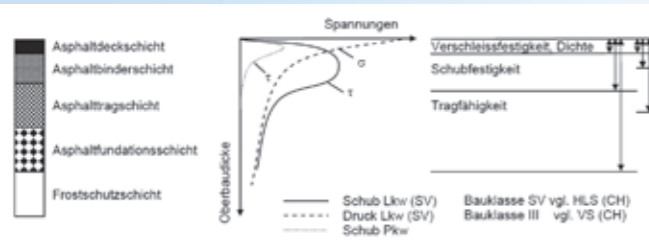
Abb. 4: Zuordnung der Eigenschaftsanforderungen sowie schematische Darstellung der Schub- und Druckspannungen in Abhängigkeit von der Schichtstärke und die daraus folgenden Funktionen der Schichten (schematisch) [10]
