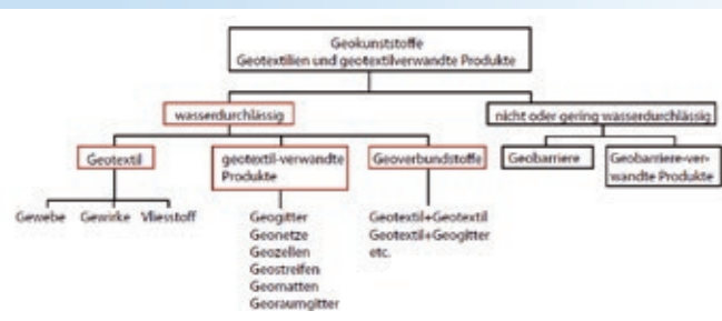
Abb.5: Zuordnung von Asphalteinlagen (Müller-Rochholz) [10]
