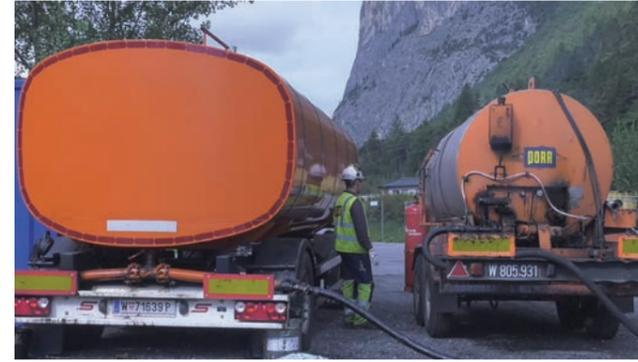
Die eingesetzten Gerätschaften sind täglich auf ihre Gebrauchsfähigkeit zu prüfen (Servicetank, Lagertank, Pumpen) um optimale Einbauleistungen erreichen zu können.
