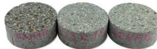
Abbildung 6: Betonoberflächen nach Oberflächenvorbehandlung (v.l.n.r. HöDW, K, K+HDW)
