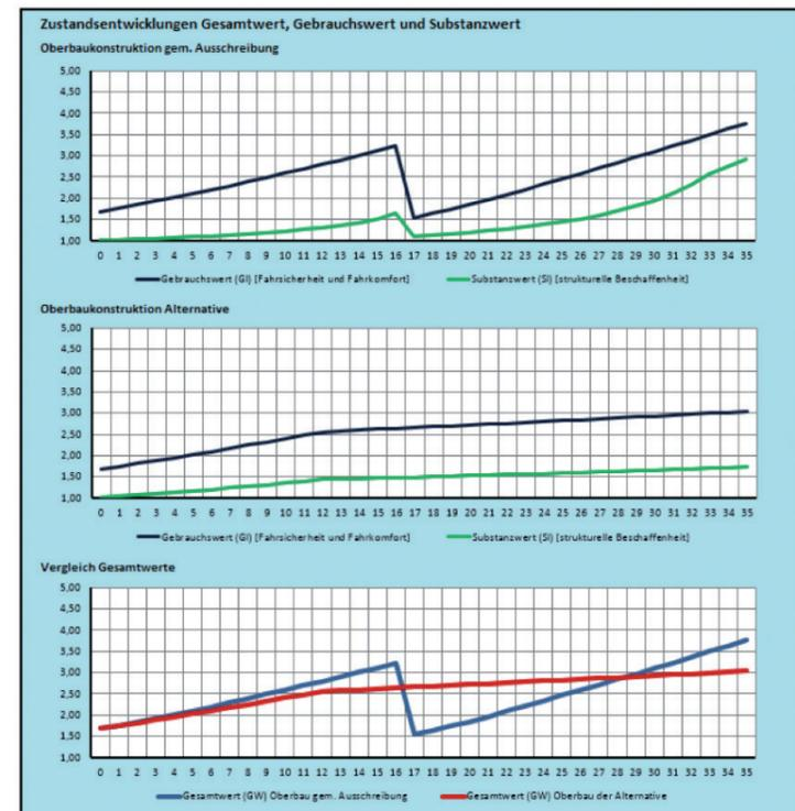
Abb. 3: Zustandsentwicklung Teilwerte und Gesamtwert als Vergleich beider Varianten
