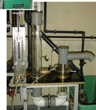
Der Nachweis der erforderlichen Filtereigenschaften wird anhand von Wasserdurchlässigkeit und Öffnungsweite erbracht. Die entsprechenden Prüfgeräte, mit denen produktionsbegleitend eine kontinuierliche Qualitätssicherung erfolgt, sind am Bild dargestellt (Quelle: Polyfelt).
