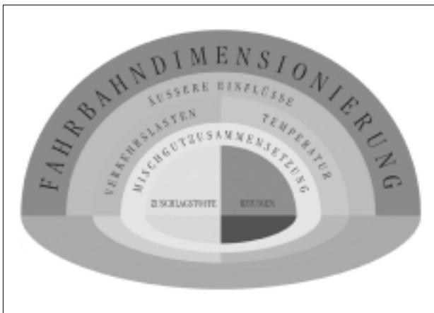
Abb. 1: Parameter einer optimierten Fahrbahndimensionierung
