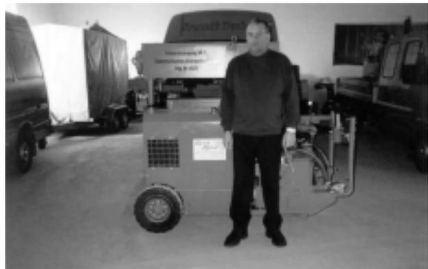
Ein großer Vorteil liegt darin, dass die Fräserabsaugung HK 1 auf herkömmliche Rissefräsen montiert werden kann und es zu keiner Veränderung der Rissefräse in Breite und Länge kommt. Die Absaugung wird in die Höhe aufgebaut.
