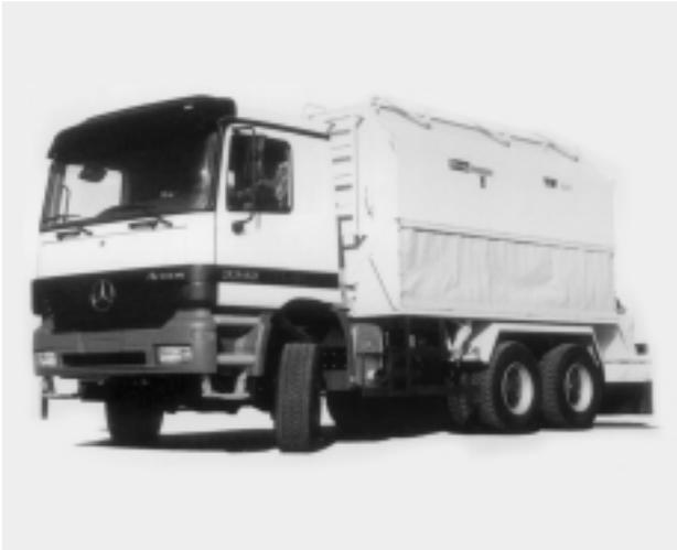
Abb. 6: Großraumzementverteilergerät als Aufbau-
