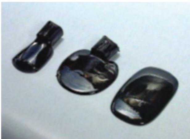
Abb. 1: Von links: nicht homogen, nicht homogen, homogene Ausbreitfigur
