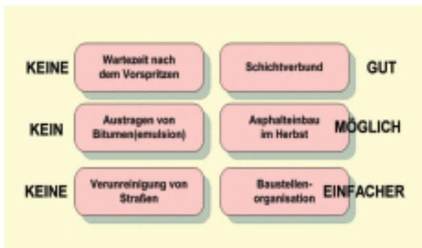
Abbildung 17: Vorspritzen mit Fertiger - Einflüsse
