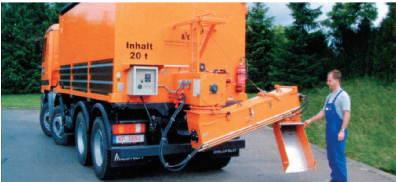
Die eingebaute Förderschnecke sorgt für eine fein dosierbare Ausbringung des Mischguts
