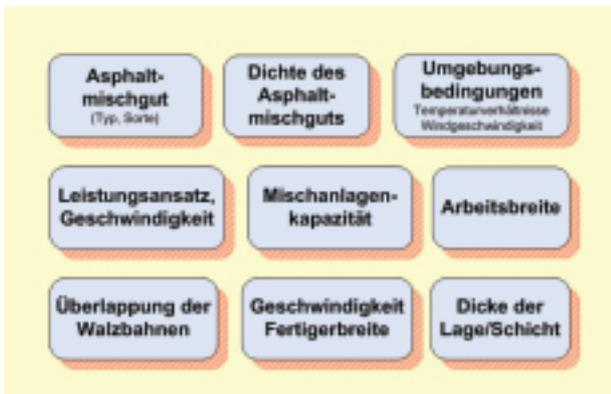
Abb. 3: Einflussgrößen auf den Einbau und die Verdichtung
