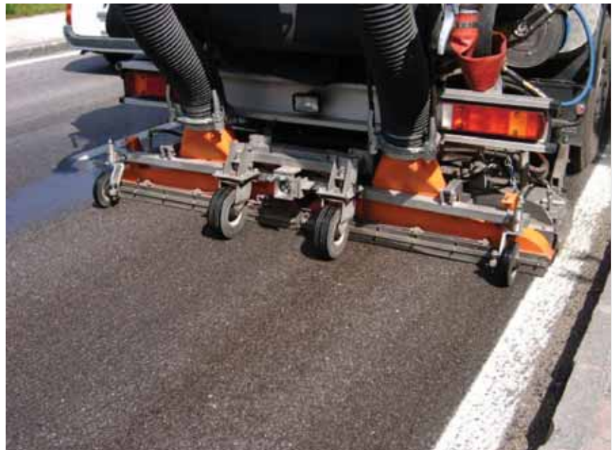
Beispiel: Bodenabstand der Düsen
