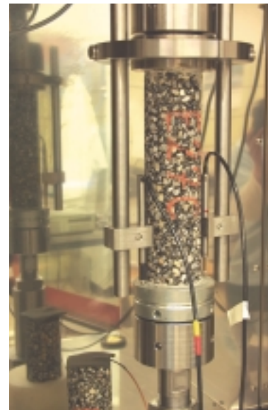
(a) Zug - Druckprüfung
