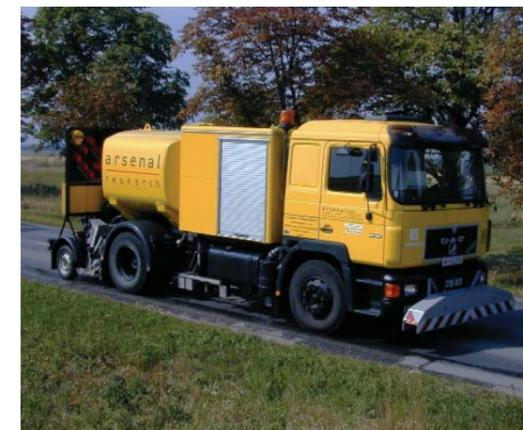
siehe Abbildung 0-1) erhoben. Abbildung 0-1: Messfahrzeug RoadSTAR (Foto Arsenal Research)
