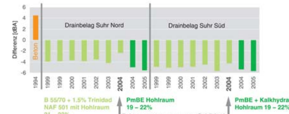
Abb. 5a: Lärm-mindernde Wirkung des Drainasphalts im Kanton Aargau über einen Zeitraum von 5 Jahren (Quelle: Département Bau, Verkehr und Umwelt des Kantons Aargau, Abteilung Tiefbau/Lärm)
