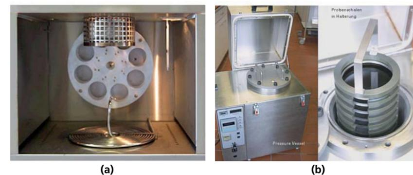
Abbildung 5: Bitumenalterung: (a) RTFOT (b) PAV
