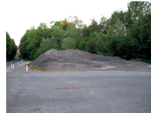
Abb. 02: Zwischengelagertes AGR-Material
