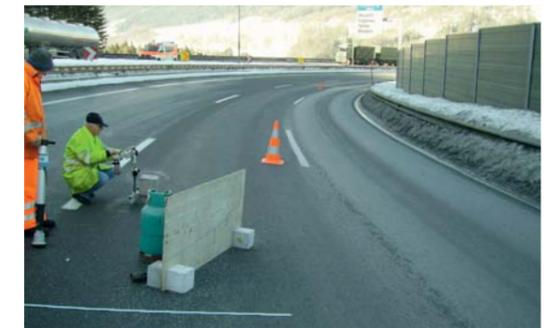
Bei der Prüfung mit diesem Skid-Resistance-Tester gemäß ÖN EN 13036-4 wird die Reibungsenergie gemessen und lässt sich daraus die Griffigkeit der Fahrbahnoberfläche einordnen und bewerten. Eine
