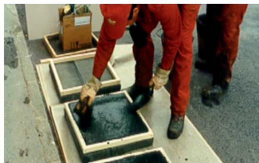
Bild 23: Prüfkörper für Gussasphaltverträglichkeit
