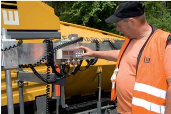
Polier Reinhold Schopf kalibriert die Ultraschall-Höhenfühler des Big-MultiPlex-Ski an der Bedienkonsole.
