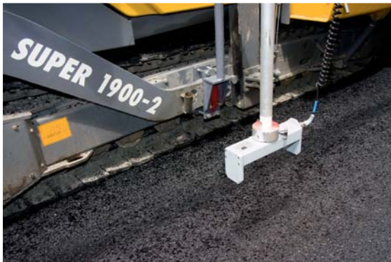
Der Big-MultiPlex-Ski ist, wie alle Ultraschall-Sensoren, sehr flexibel einsetzbar. Die Sensorhöhe kann variabel zwischen 200 und 650 mm eingestellt werden.
