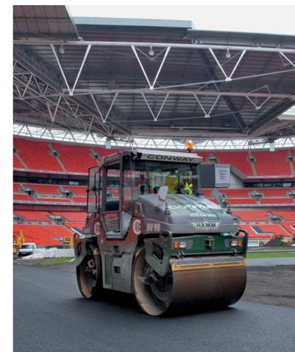
Die Großraum-Panoramakabine der Allrad gelenkten Tandemwalze mit Doppelvibration vom Typ DV 90 bot dem Fahrer einen freien Blick auf die Bandage
