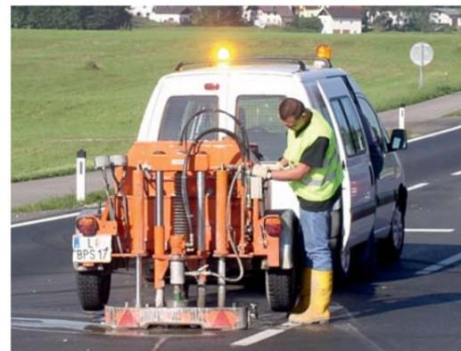
Foto 06: Bohrkerngerät
