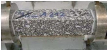
Abbildung 7: Probekörper für den zentrischen Zugversuch (mit angeklebten Adaptern) (ISBS, TU Braunschweig) (Foto: TU Braunschweig).
