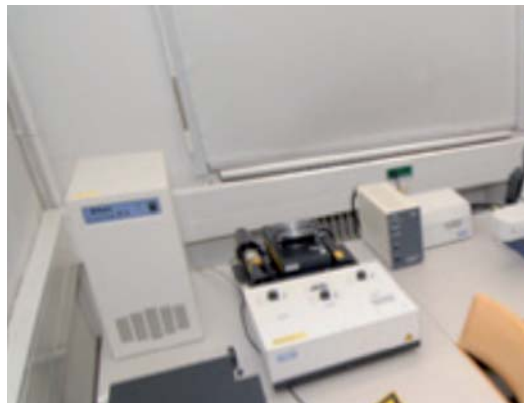
Abbildung 3: Mikroskope, die u. a. am USTEM der TU Wien zum Einsatz kommen: cryo Environmental Scanning Electron Microscopy (links) und Confocal Laser Scanning Microscopy (rechts) (Quellen: TU Wien).
