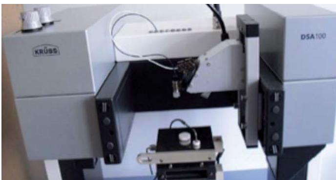
Abbildung 4: Messung des Kontaktwinkels am Bitumentropfen: Messeinrichtung (links) und Prinzipskizze (rechts).
