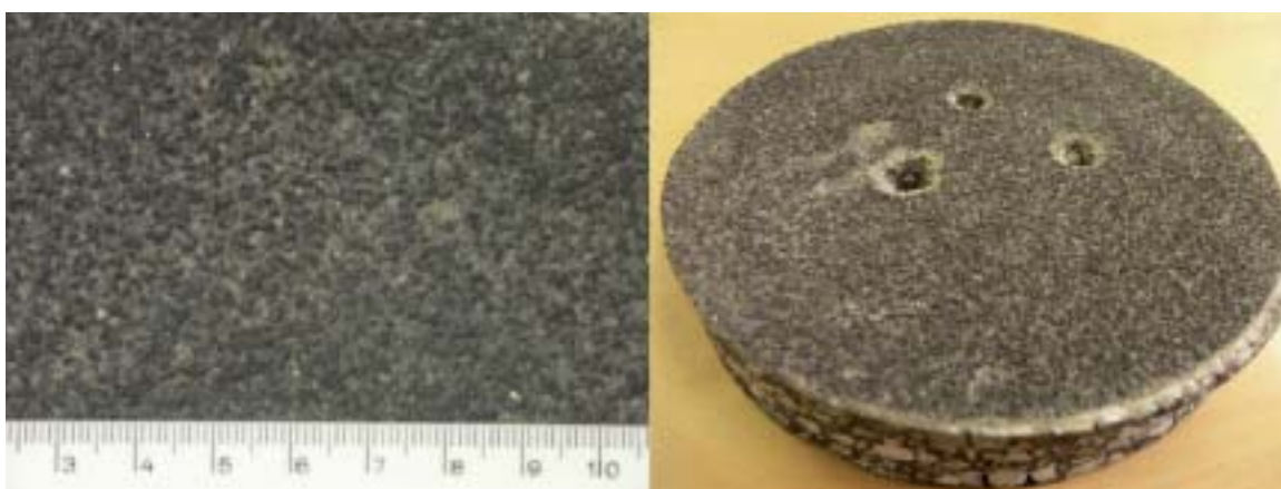
Abbildung 3: Deckschicht B - Probekörper mit abgestreuter RESIST-2K Beschichtung
