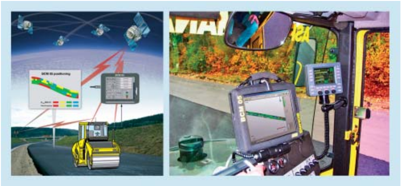
Bild 12: GPS gestützte flächendeckende Dokumentation der Verdichtung mit BCM05
