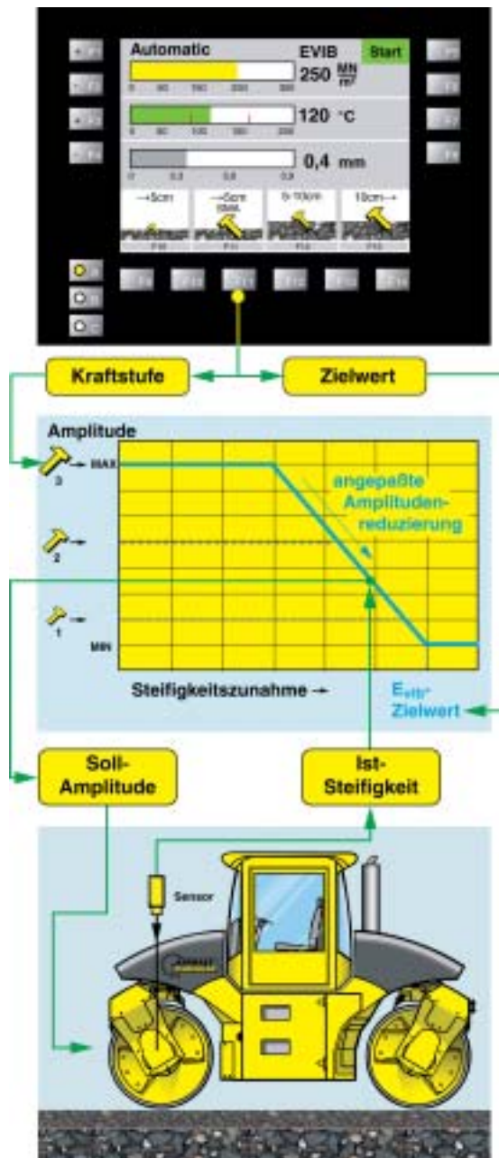
Bild 6: Bedien- und Regelungskonzept der neuen Asphalt Manager Generation
