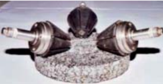
Abbildung 5: Anordnung der drei Polierrollen auf der Prüfkörperoberfläche [3]
