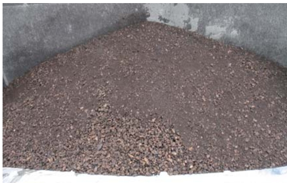
Abb. 5a Aufnahme des Trockenmischguts AC 16 ohne Frischbitumen, aber mit 20% RA direkt nach dem Mischer
