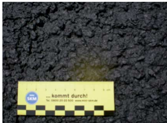
Fräsfläche nach Reinigung mit Saugkehrwagen
