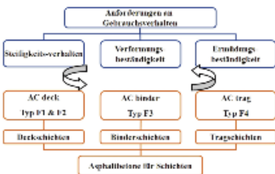
Abbildung 1: Überblicksschema für Asphaltbetone nach GVO Ansatz und deren Mischguttypenzuordnung in der Fassung aus dem Jahre 2006 [Kappl 2010]
