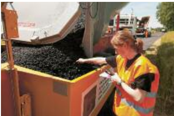
Temperatur-Messung auf der Baustelle durch das Ammann Forschungsteam: Das Thermometer zeigt lediglich 110°C
