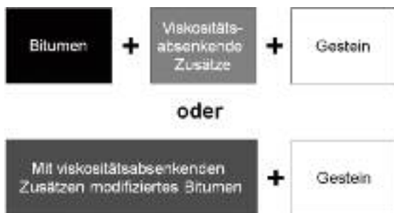
Bild 1: Zusammensetzung von Niedrigtemperaturasphalt
