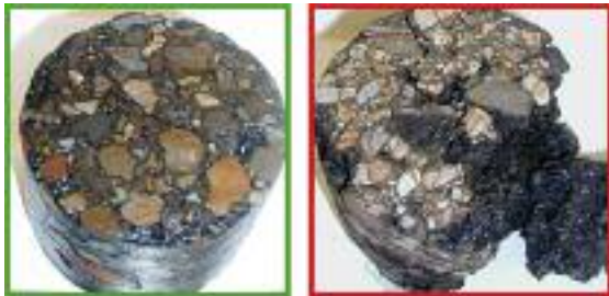
Abbildung 4: links mit Kalkhydrat; rechts ohne Kalkhydrat
