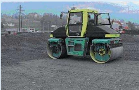
Abb. 4 Asphaltwalze misst Steifigkeit des Untergrundes
