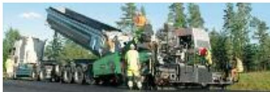
Der „Sprayjet“ ist eine Spezialmaschine, die den Haftkleber oder die Emulsion samt Asphalt in einem Arbeitsgang einbaut. Durch das Aufsprühen vor dem Mischgut kommt es nicht zum Überfahren der Kleberschicht durch Baustellenfahrzeuge und damit zu keiner Verschmutzung des Haftfilms und im umliegenden Straßennetz. Genau dosierte Sprühmengen gewährleisten einen 100%igen Verbund zwischen den Lagen.
