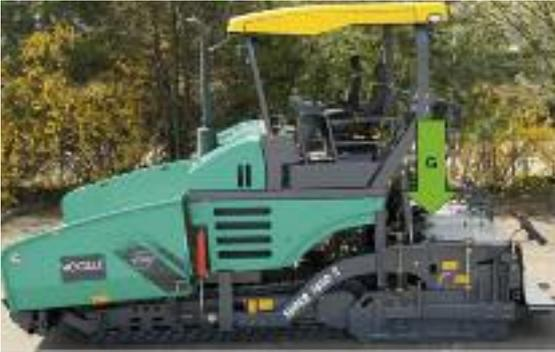
Das Gewicht der Einbaubohe ist konstruktiv konstant, kann aber durch die Funktion „Bohlenentlastung“ hydraulisch beeinflusst werden.
