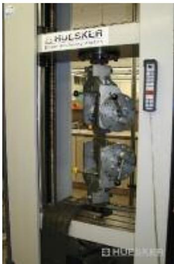
Bild 3: Zugversuch am breiten Streifen nach EN ISO 10319
