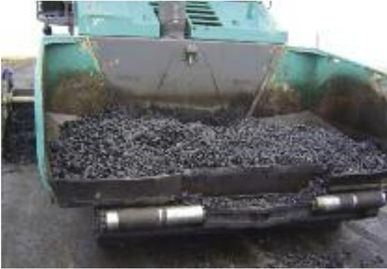
Entmischung kann entstehen, wenn großer Korngrößenunterschied und geringer Bindemittelgehalt zusammen spielen. Abhilfe: Betätigung der Bunkerwände ist zu reduzieren und der Bunker sollte nicht komplett leer gefahren werden.
