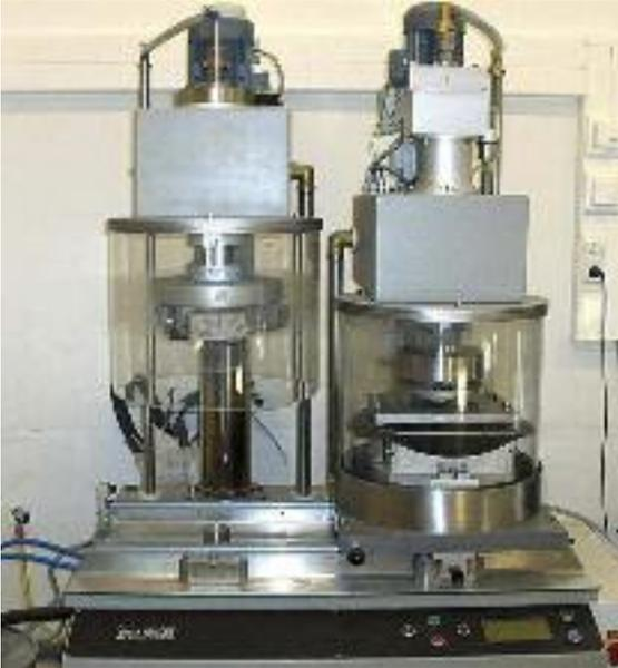
Abb. 3: Prüfanlage nach Wehner / Schulze in der TPA Wien
