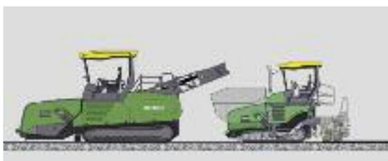
Es gibt z.B. einen Bonus in der Höhe bis zu 15% für den Einbau mittels Beschicker, um dabei eine bessere Wärmeverteilung zu erhalten, da auf diesem Gerät eine Zusatzheizung aufgebaut ist, wodurch an den Fertiger ein homogeneres Mischgut übergeben wird. Außerdem erfolgt der Einbau ohne Stopps mit kontinuierlicher Fahrgeschwindigkeit.
