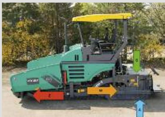
Grundsätzlich besteht ein Fertiger aus einer Zugmaschine (Rad oder Ketten getrieben) und einer gezogenen, auf dem heißen Mischgut frei schwimmenden Bohle. Im Einbauprozess wird dabei der Asphalt auf die Einbaustärke über die volle Breite verteilt, glatt gezogen und vorverdichtet.
