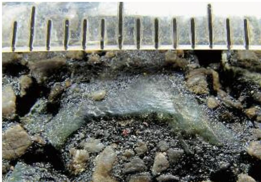
Abb. 2: Asphaltoberfläche nach Polierbeanspruchung. Poliertes grobes Gesteinskorn in der Mitte, darunter zT sehr feine Gesteinskörnung, die eine Mikrotextur ähnlich der von Sandpapier aufweist. Ganz oben die Millimetrierung eines Lineals.
