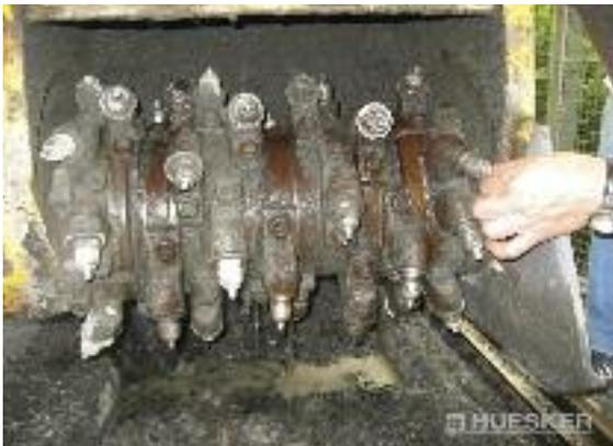
Bild 20: Nahezu keine Fasern haben sich um die Fräswalze gelegt
