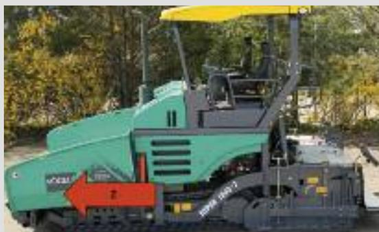
Die Zugkraft beeinflusst und bestimmt die Einbaugeschwindigkeit. Es macht keinen Sinn, z.B. eine hohe Einbaugeschwindigkeit zu wählen wenn zu wenig Mischgut auf der Baustelle zur Verfügung steht und man damit den Einbauprozess permanent unterbricht. Die Geschwindigkeit sollte grundsätzlich während des Einbaus konstant gehalten werden, um ein qualitativ gutes Einbauergebnis zu erreichen.
