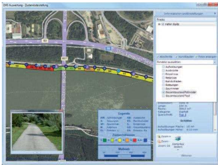
Abb. 11: Darstellung der Zustandsauswertung mit Gesamtnote und Schadensbildern im EMS - Tool.
