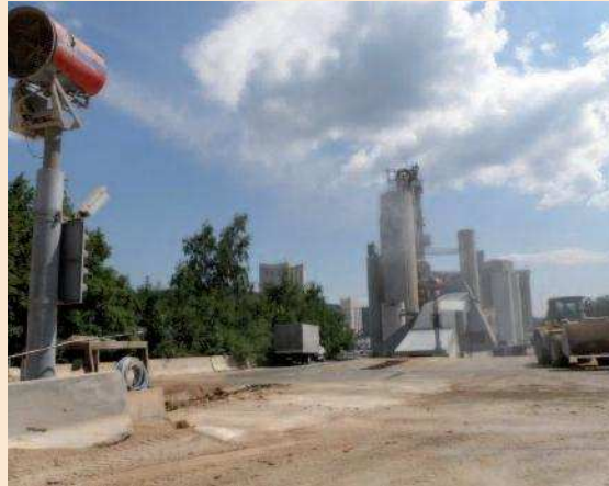
Abbildung 2: Staubbekämpfung bei Verladung (Quelle Firma IAG Produkt ESM150 Staubbindemaschine)
