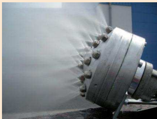
Abbildung 6: Düsenkopf (Quelle: Firma IAG DK20)
