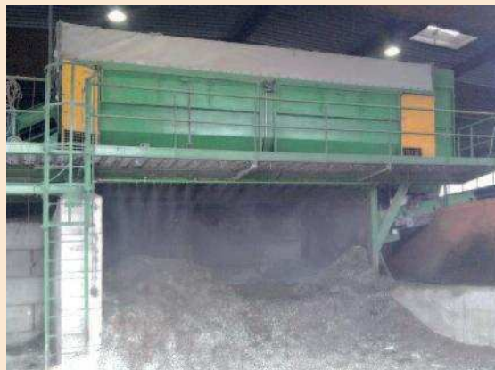
Abbildung 3: Staubbekämpfung bei einer Siebanlage (Quelle Firma IAG Produkt DLS - Düsenleitungssystem)
