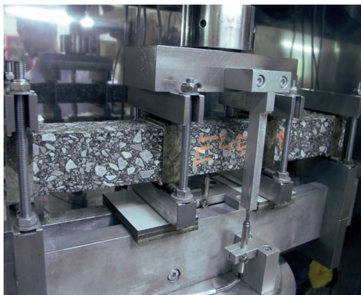
An dieser Anlage findet die dynamische Biegeprüfung statt
