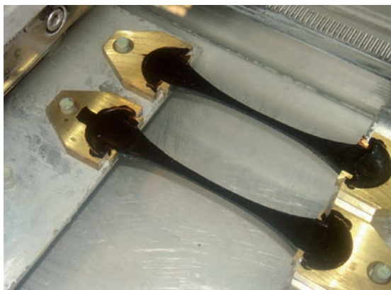
Ein Bitumenbalken wird auf Dehnbarkeit getestet
