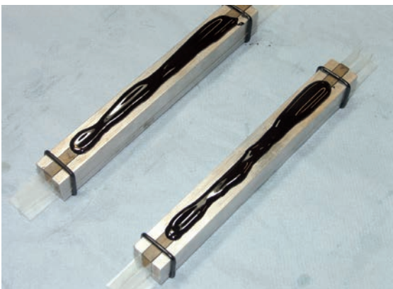
Ein Bitumenbalken wird bei tiefen Temperaturen (-24°) belastet
