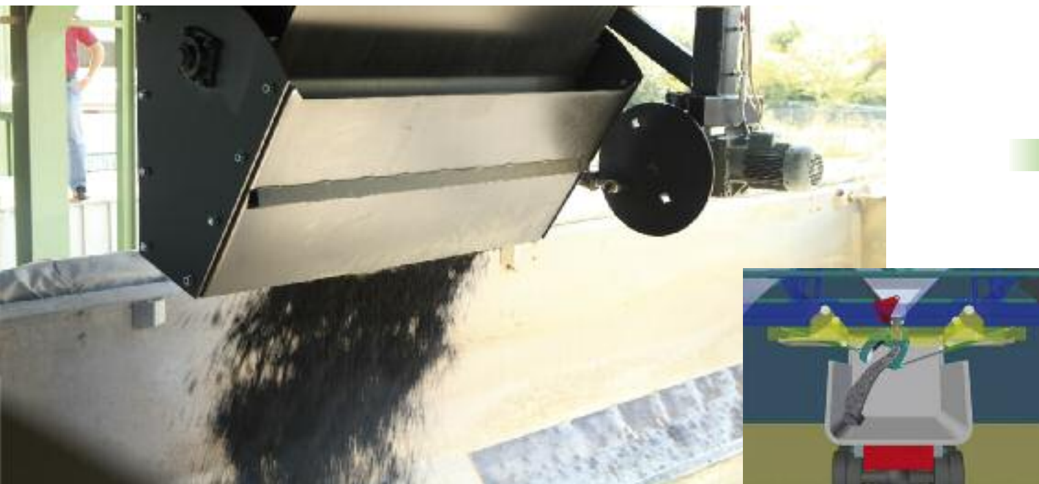
Abb. 213: Mischgutbefüllung mit schwenkbarer Übergabevorrichtung
