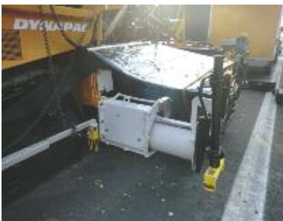
Bild 6: Mischgutquerverteilung mit Schneckenhalbschale und Schneckenraumabdeckung
