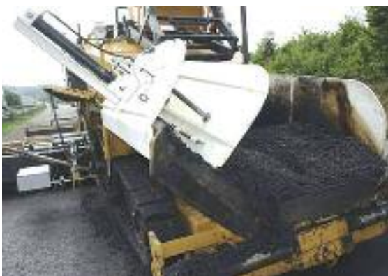
Bild 5: Fertiger mit schieb- und kippbaren Bunkerwänden
