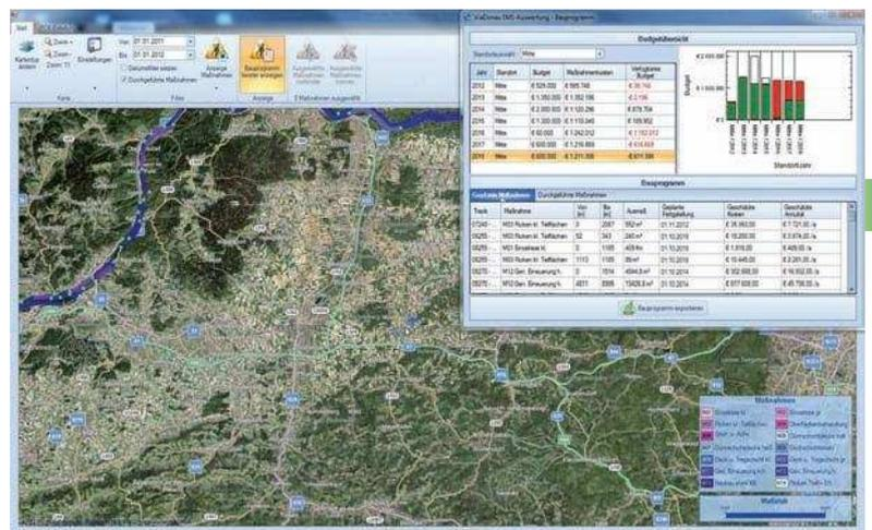
Bild 17: Manuelle Maßnahmenplanung per „drag and drop“ mit Kostenermittlung auf Basis der Einheitskostenfunktion und Optimierung auf Basis minimaler Annuitäten im Track
