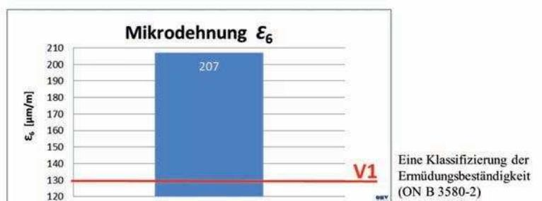
Bild 5: Ermüdungsbeständigkeit AC 22 binder
