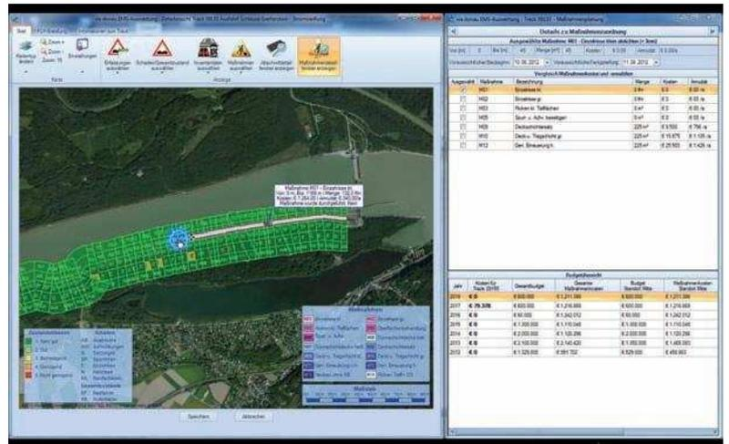
Bild 16: Manuelle Maßnahmenplanung per „drag and drop“ mit Kostenermittlung auf Basis der Einheitskostenfunktion und Optimierung auf Basis minimaler Annuitäten im Track
