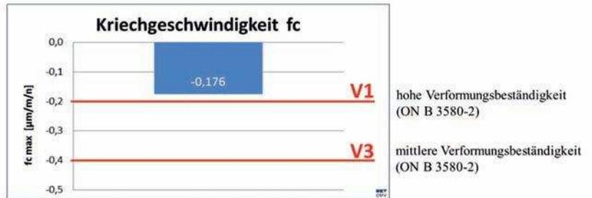
Bild 3: Verformungsbeständigkeit AC 22 binder
