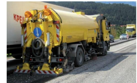
Spezialreinigen von Asphaltoberflächen mit Hochdruckwasser  $\geq 300$  bar
