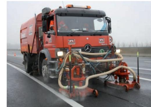
Trimix – Gerät mit zwei Aufrau-Einrichtungen
