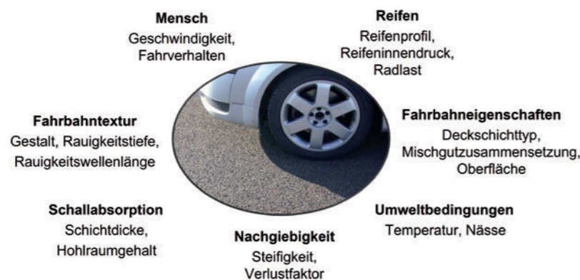
Abb. 3: Einflussfaktoren auf die Rollgeräusche (eigene Darstellung basierend auf Manuel Sánchez, 2019)
