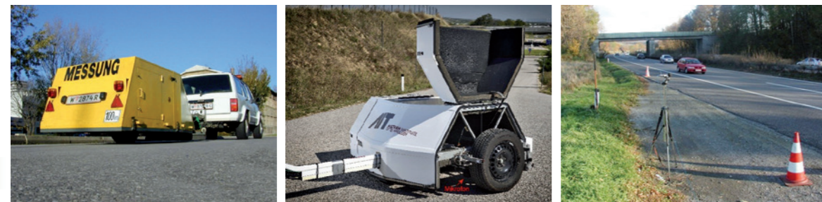
Abb. 6: Messverfahren zur Erfassung des Einflusses von Fahrbahndecken auf die Lärmemission (links: RVS 11.06.64, Mitte: ISO 11819-2 (CPX), rechts: Rollgeräuschmessung nach ISO 11819-1 (SPB))
