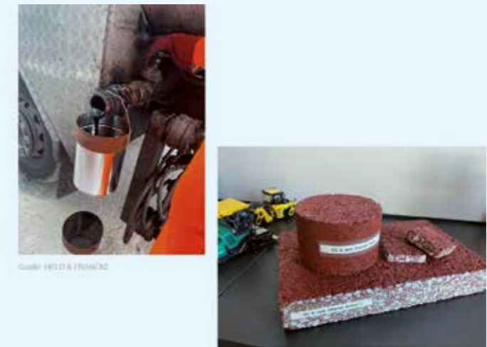
Abb. 6: Überprüfung der Praxistauglichkeit und Optimierung des roten Asphaltmischgutes im Labor
