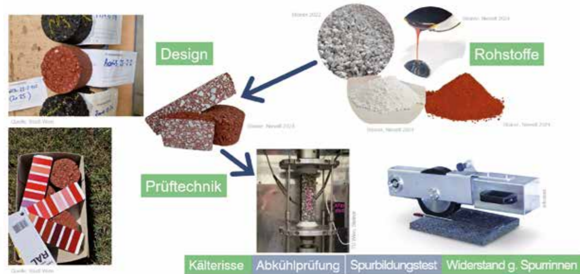
Abb. 5: Entwicklung des Mischgutkonzeptes für roten Asphaltbelag
