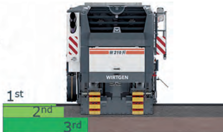
Bild: Abtragen der Asphalt-schichten ist bei hohen Recyclingquoten zwingend erforderlich
