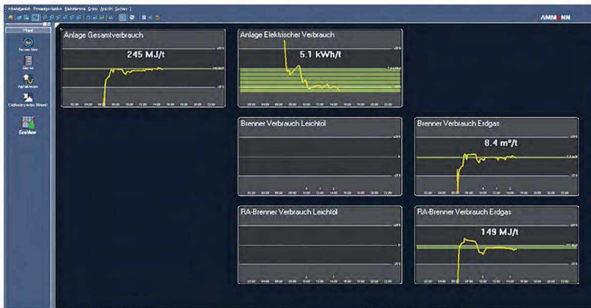
EcoView, der Bord-computer der Asphaltmischanlage
